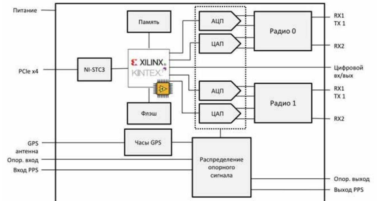
Каждое устройство оснащено двумя парами высокоскоростных АЦП и ЦАП, мощной ПЛИС и содержит два слота для установки дочерних ВЧ плат, определяющих диапазон частот сигналов. Типовые комплектации используют дочерние платы CBW, WBX, SBX.
